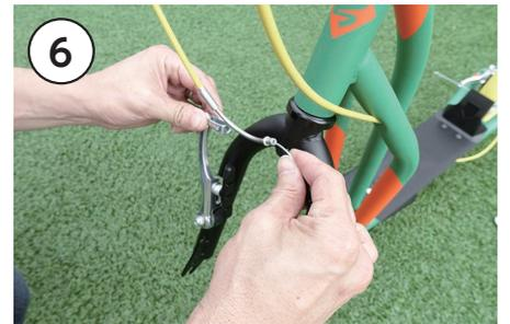
6 後輪と同じようにVブレーキのロックを外します。
