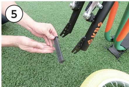
5 K B 2本体の前輪部の保護材を外します。
