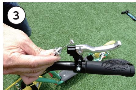
3 左右入れ替えれば、左右のブレーキの入れ替えが完了します。
