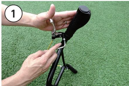
ブレーキレバーの固定ネジは下側にあります。5mmの六角レンチを使用してネジを緩めて調整します。
