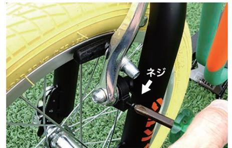
ブレーキパッドとリムの隙間が左右同じぐらいに調整します。
