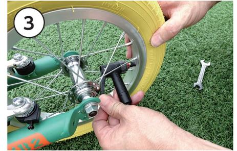
タイヤの空気バルブの黒キャップを外し、空気を280kPaまで入れます。
