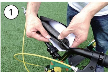
ハンドル上部中央にハンドル保護カバー（丸筒）を取り付けます。マジックテープを剥がすと中のスポンジに切り込みが入っていますので、ハンドル中央部に装着します。
