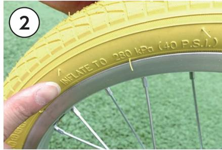
タイヤの空気を入れます。最大空気圧は280kPa(40P.S.I)です。最大空気圧を超えるとパンク、タイヤの変形などの原因になります。
