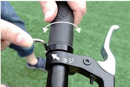
3mmの六角レンチを使用しグリップ左右にあるネジを両方緩めます。グリップを握り、丁度良い角度に調整をし、再度ネジを締めます。基本はハンドルに手を置いた際に手の平が当たる部分にグリップの平面が来るようにします。お好みでもかまいませんが、グリップのネジの締め忘れにはご注意ください。
