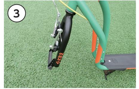
3 前輪取り付け部をVブレーキが前になるように回転します。
