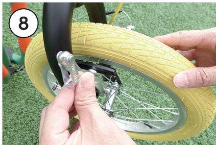
8 後輪と同じようにブレーキパッドを90度回転します。前のブレーキパッドにも曲面がありますので、曲面側をタイヤのゴム側になるようにします。
