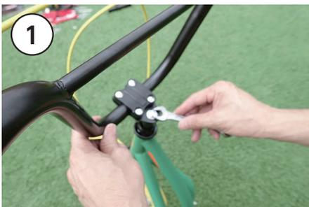
1 ハンドルを取り付けます。高さを調整しながら上部のナットを12mmのスパナで締めていきます。
