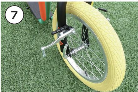
7 前輪を取り付けます。本体左側にクイックリリースレバーが来るように取り付けます。ナットとレバーを回転させて締めていき、最後にレバーを倒して固定します。
