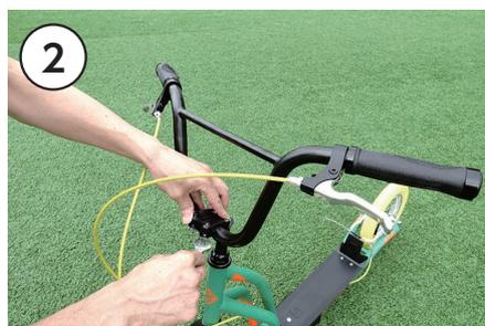
13mmのレンチ(スパナでも良い)で4つのナットを緩め、ハンドルバーが地面と垂直になるように調整をします。
